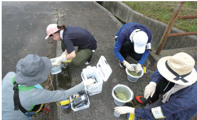
ため池で採取した水試料はpHなどを現場で、温室効果ガス濃度を実験室で測定します。
